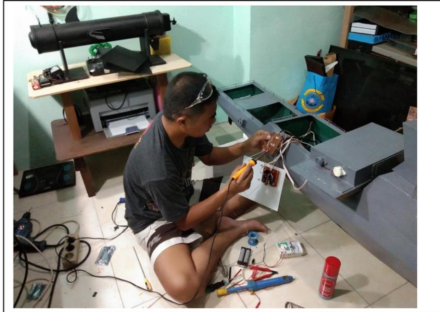
**Gambar 14.** Pemasangan Rangkaian Pada *Prototype* Kapal
