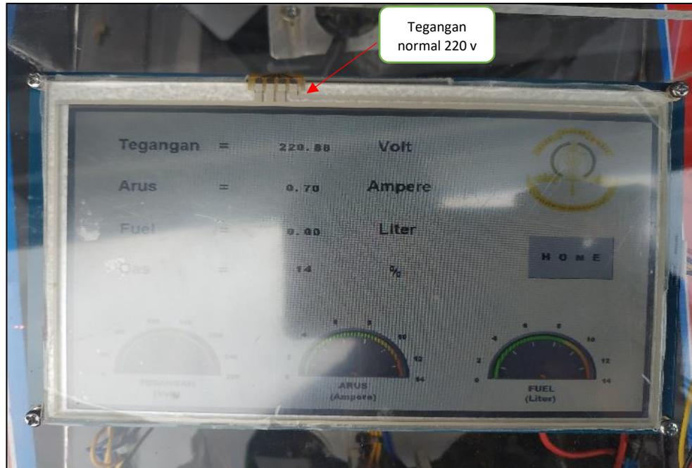
**Gambar 16.** Tampilan Tegangan pada LCD.
