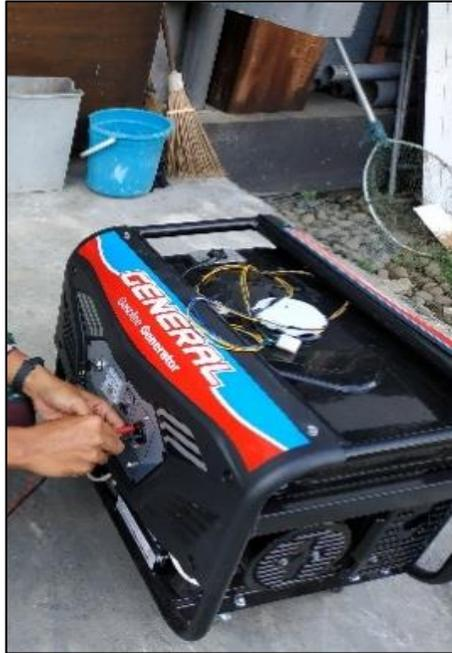
**Gambar 15.** Pengukuran Genset Menggunakan *Volt Meter*.
