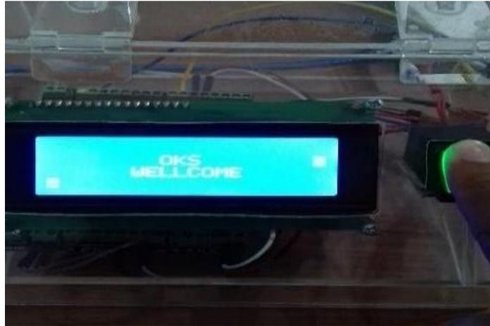
**Gambar 12.** Pengujian Sensor *Finger print* Terdeteksi
