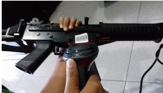
**Gambar 14.** Pengujian Sensor *Barcode*
